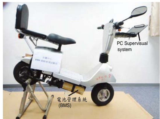
圖 3-1-4-4 搭載於輕型電動載具之電池管理系統
