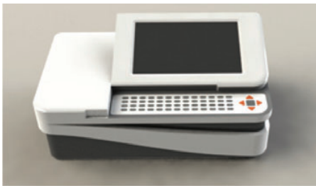
圖 3-1-3-3 光纖式奈米生物感測儀第 3 代原型機設計圖
