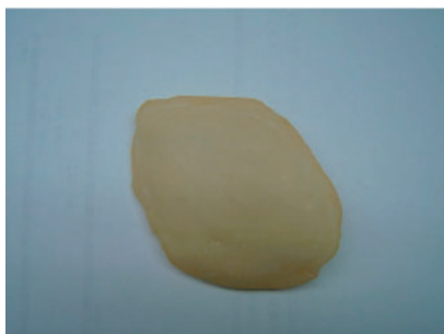
圖 3-7-3-6 臨床手術用之補骨植入物，由本系統設計好再輸出給原型雕刻機製作完成。
