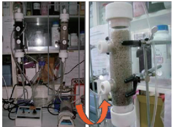
圖 3-6-6-2 砂濾試驗裝置
