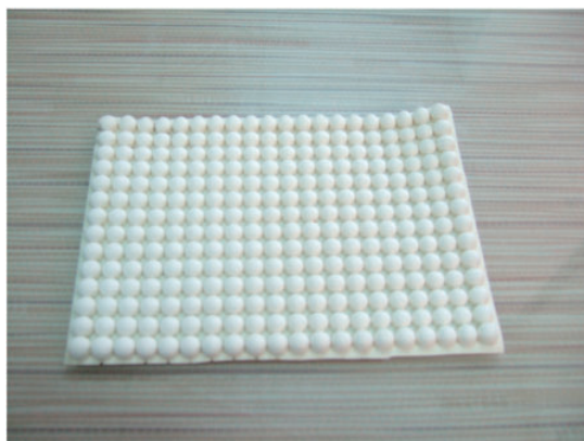
圖 3-4-4-6 織物與耐燃發泡材貼合成型
