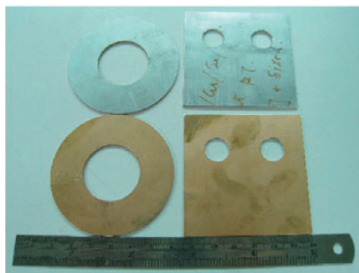
圖 3-4-3-6 變壓器用銅鋁複合轉接板
