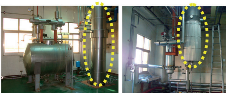
圖 3-4-2-3 本計畫所設計之蒸餾塔外觀，左圖為蒸餾塔上部，右圖為蒸餾塔下部。
