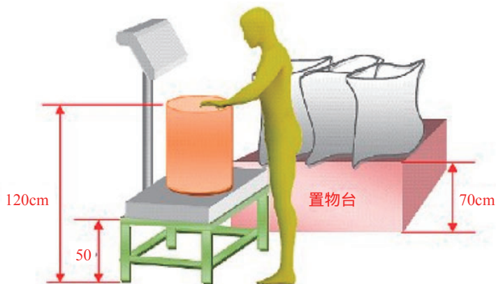
圖 3-4-1-3 麵包加工廠原物料秤重作業之人因工程改善
