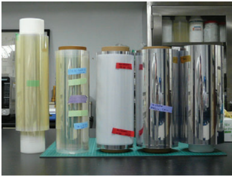
圖 3-2-3-4 從右到左依次為 TAC 原膜，及經硬質、抗眩、低反射、補償等表面處理後之膜材
