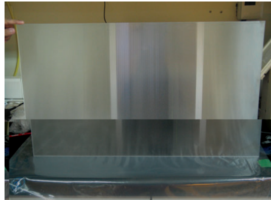
圖 3-2-3-6 32吋具表面菱鏡結構之光擴散板
