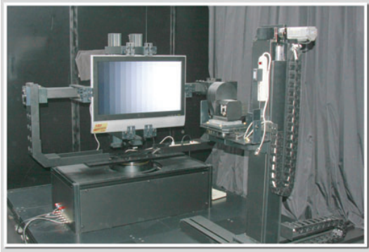
圖 3-2-3-7 大面板與電視量測裝置
